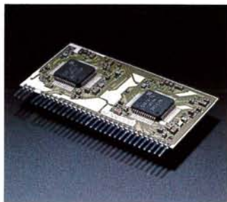
● Il nuovo IC ibrido originale Kenwood dispone sia del sistema di riduzione del rumore Dolby-S sia del sistema Dolby B/C NR. Due chip attivano il controllo in tempo reale nel modello a tre testine.
